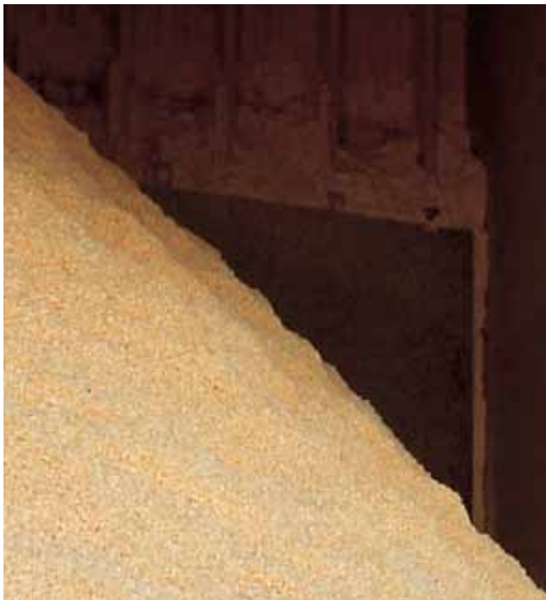
Kuvassa suurennois kutteripurukasan pinnasta. Kekukulma on jyrkkä. Sirontaa tapahtuu pinnan epätasaisuuksista. Sironnan hyödyntäminen edellyttää älykkään signaalialgoritmin käyttöä etenkin kapeissa siiloissa.
