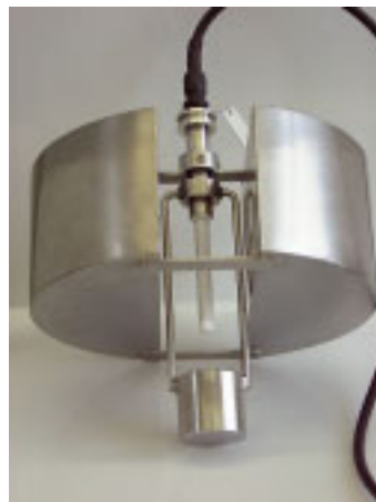
Öljynerotuskaivon rajapinta-anturi asennettuna uimuriin. Laitteella on mahdollista mitata rajapintaa myös silloin, kun kokonaispinta muuttuu.
