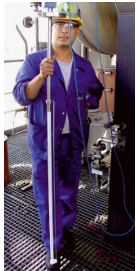
Sauva-anturia käytetään säiliöissä ja reaktoreissa toteutettavissa rajapintamittauksissa.
