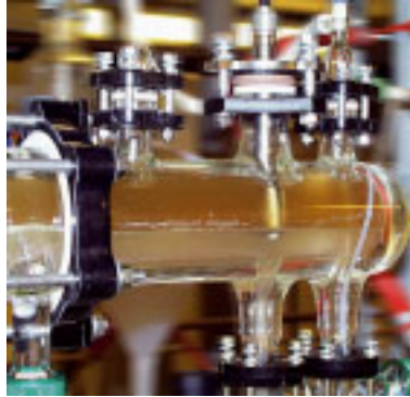
Jatkuvatoiminen rajapintamittaus asennettuna lasista valmistettuun erotusdekantteriin.
