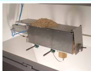
Kuva 2: ACO-kosteusmittaus näytteenottimella, voidaan asentaa esim. purkuhinnan pudotuspisteeseen.
