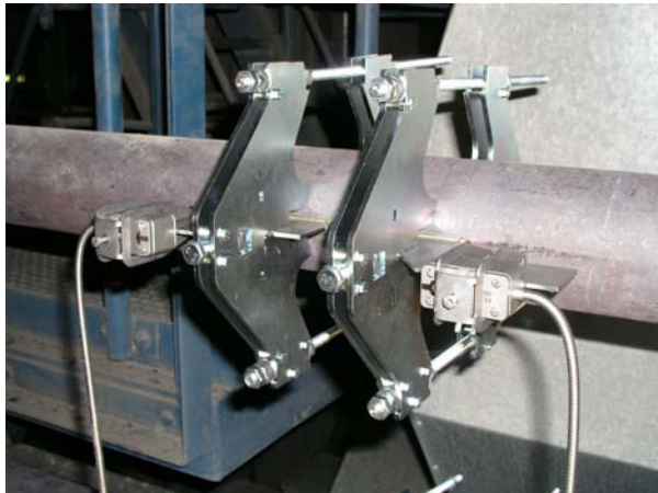
Waveinjector-aalto-ohjaimia ja "Clamp On"-antureita käytetään kuvan kuumen bitumin mittauksessa. Hopealiuskat siirtävät äänen energian aalto-ohjaimesta prosessiputkeen.
