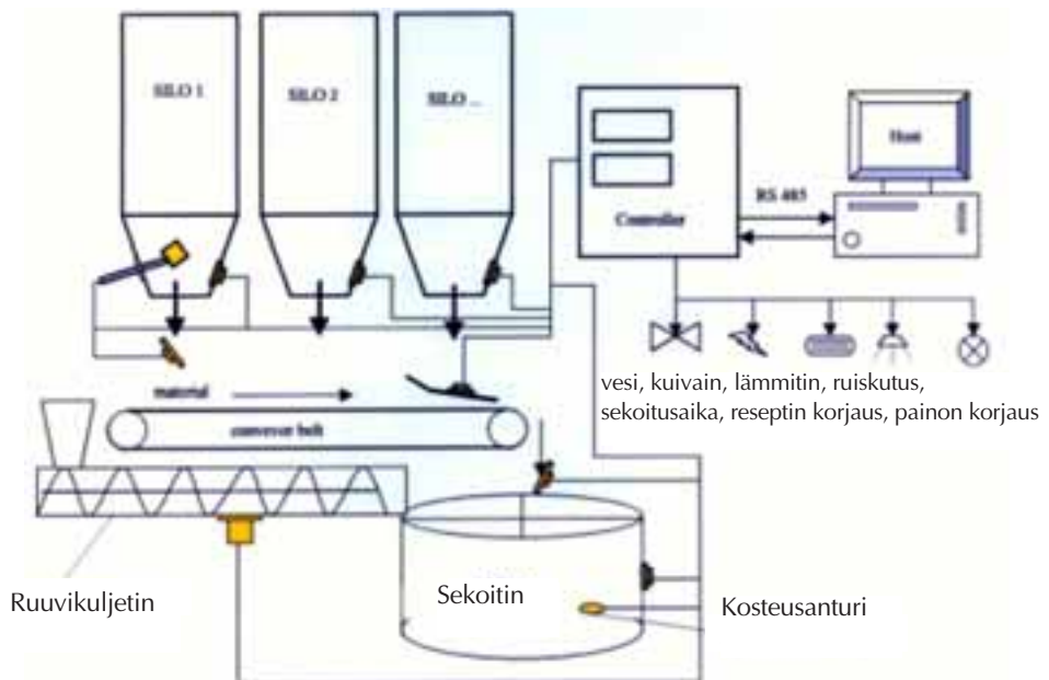
Kosteusmittauksen sijoitus prosessiin
