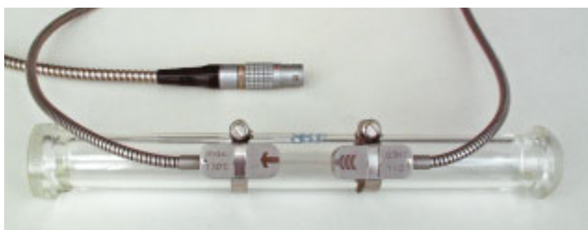
Kuva 5. Anturit asennettuna mittausputkeen
