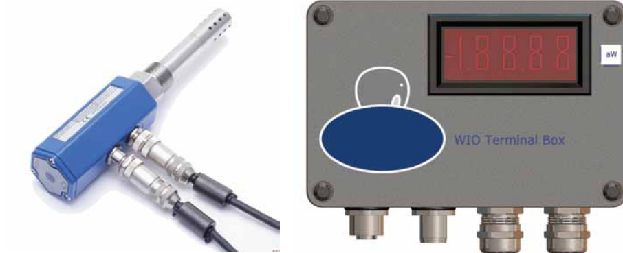
KUVA 3. Mittausjärjestelmä koostuu anturista ja liittätarasiasta, joka voidaan varustaa mittausarvon näytöllä, aseteltavilla varoitus- ja hälytyslähdeillä sekä paikallisella äänimerkkihälyttimellä.
