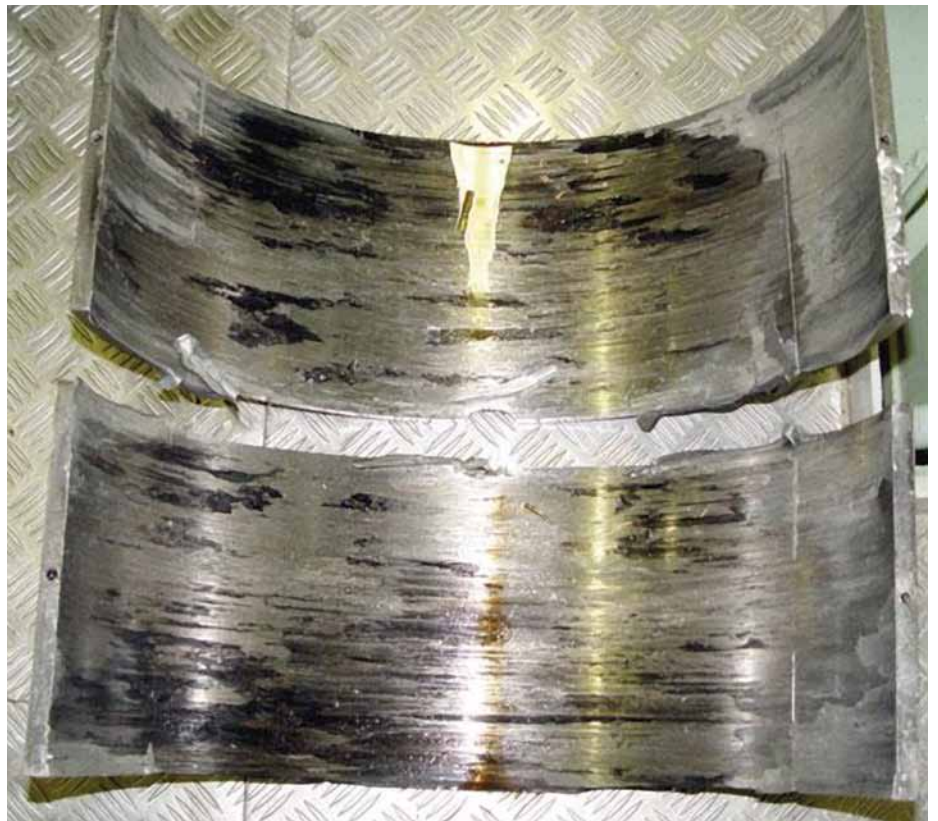
KUVA 1. Veden aiheuttama vaurio dieselmoottorin laakeripesässä.
