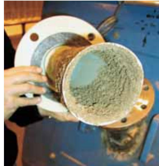
Kuvassa nähdään kaiun torven likaantuminen n. 4 kuukauden käytön jälkeen. Kartioon oli kertynyt turvepölykerros, jolla ei ollut vaikutusta mittaukseen.
